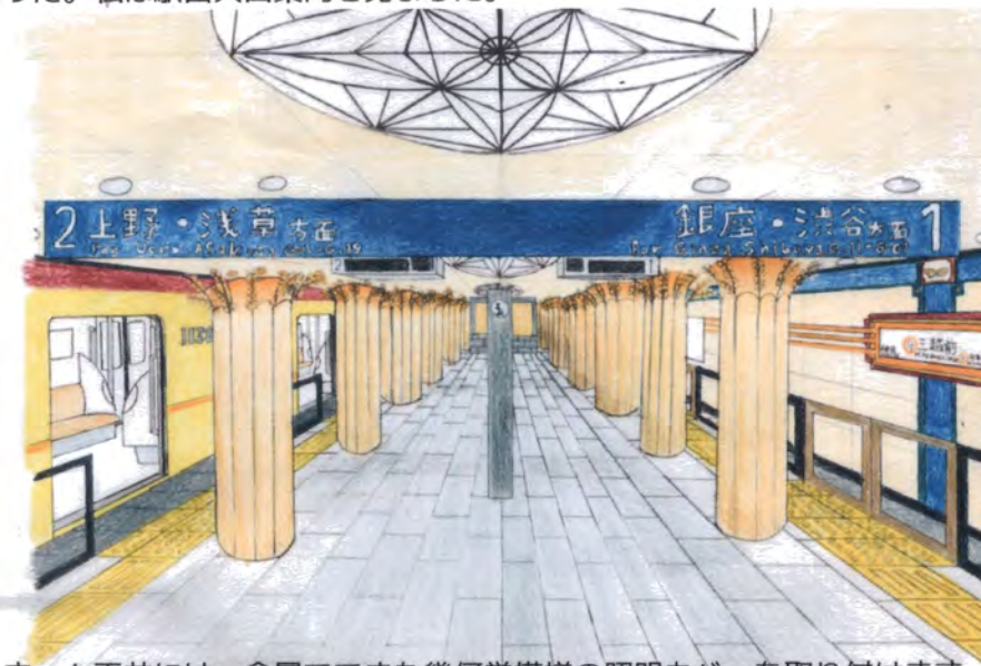
ホーム天井には、金属でできた幾何学模様の照明カバーを取り付けます。柱上部を稲穂をあしらったデザインとし、和洋融合を試みます。ホームドアは、乗降部を金色とし、固定部を黒色とすることで、ホームドアのドア部を分かりやすくします。
