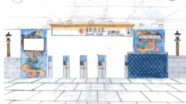
三越前駅はもともとデパートの玄関口として作られた駅なので、駅は豪華にかつ落ち着いた装飾をします。改札階の案内表示器の枠と案内所の壁には、吉兆をもたらす幻獣である鳳凰を描きます。
