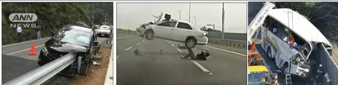
従来のガードレールは、破断して突き刺さったり、跳ね返されて重大事故になったりして凶器になりうる場合もある
